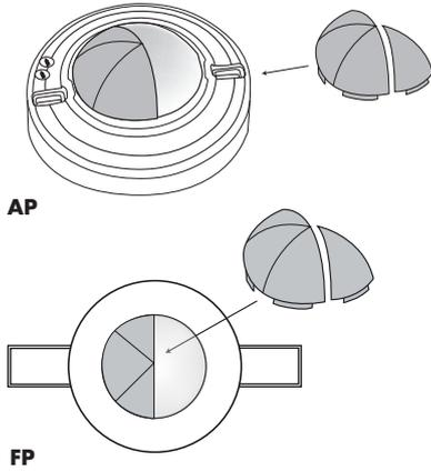
Si la zone de détection du détecteur est trop grande ou couvre des zones qui ne doivent pas être surveillées, utiliser les obturateurs fournis pour limiter la zone de détection.
